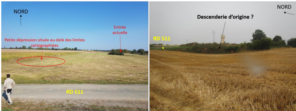
Illustration 10 : Indices de surface identifiés au-delà des limites cartographiées en souterrain, ce qui témoigne de l'emprise originelle de la cavité, plus vaste que ce qui est actuellement accessible
