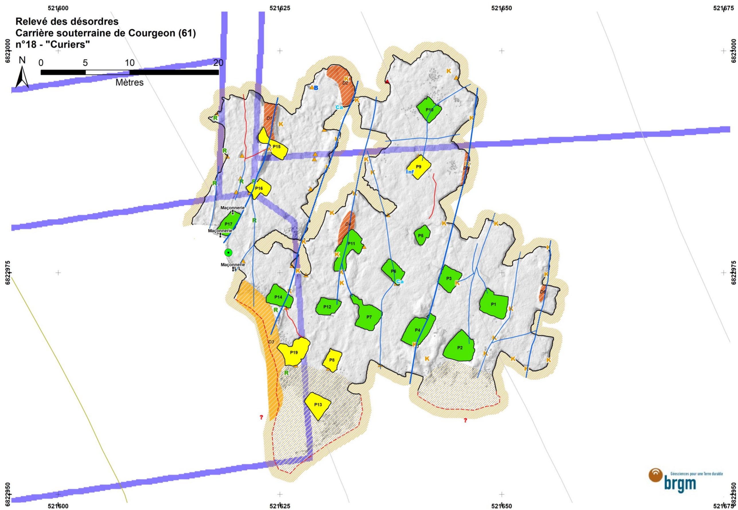
Illustration 17 : Plan de relevé des désordres de la carrière souterraine de Courgeon – lieu-dit « Curiers » (n°18)
