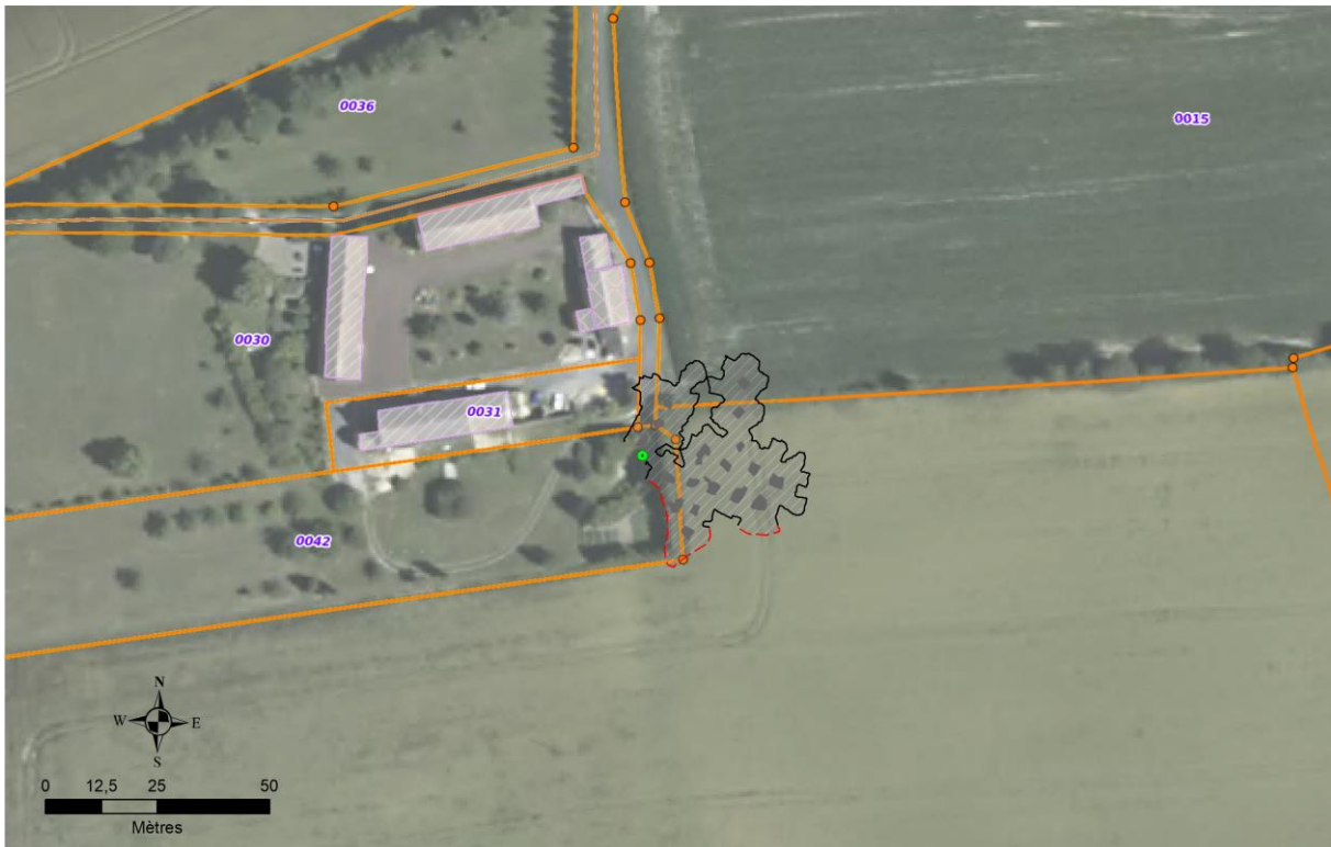
Illustration 7 : Environnement de surface de la carrière de Curiers d'après l'orthophoto et le cadastre (IGN). Les tiretés rouges correspondent aux limites supposées, au-delà desquelles des continuités sont possibles
