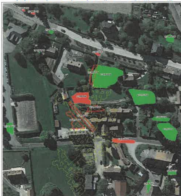
Figure III.16: anomalies géoradar au niveau de la carrière accessible (Gexplora 2017).
