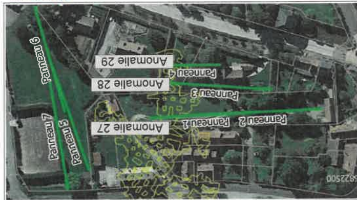
Figure III.20: anomalies détectées par panneaux électriques (Gexplora 2017).
